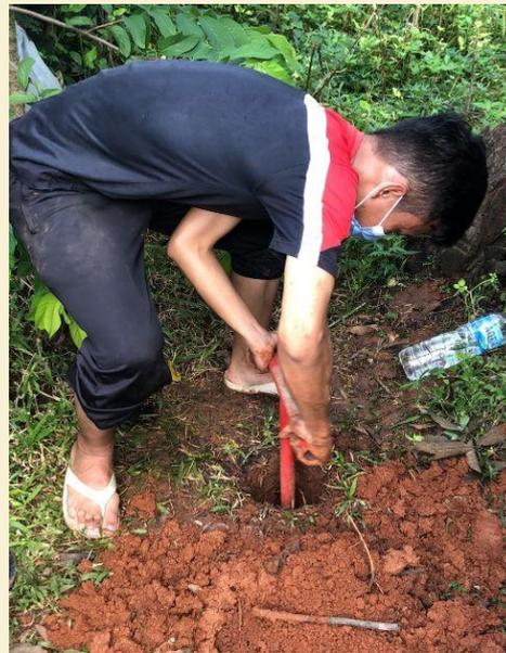
Gambar 13 Proses Bor Tanah
